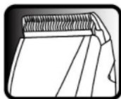
Keramikklinge mit spitzem Winkel
