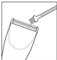
1. Nettoyer la lame avec une brosse de nettoyage.
