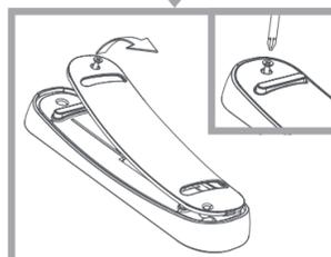
Öffnen Sie das Batteriefach.
