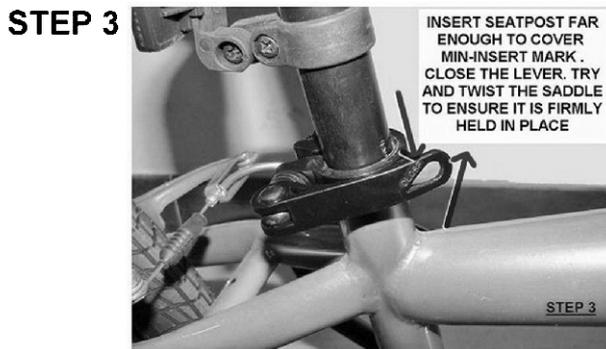
**AFTER SEATPOST IS INSERTED, YOU MUST FLIP THE LEVER TO THE CLOSED POSITION**
