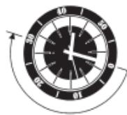
Wenn Ihre Uhr mit einem drehbaren Außenring mit Minutenkala ausgestattet ist, kann dieser Ring in verschiedener Weise zur Erfassung der abgelaufenen Zeit benutzt werden. Hat ein Taucher beispielsweise einen Atemluftvorrat für 30 Minuten, kann er den Außenring so einstellen, dass die dreieckige Markierung (0 Position) mit dem Minutenzeiger übereinstimmt, wenn er eintaucht. Der Minutenzeiger zeigt dann auf dem Außenring die Verweilzeit des Tauchers unter Wasser an.
