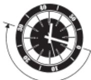
お客様の時計の外周に、分単位の回転式ダイヤルが備え付けられている場合は、様々な方法で経過時間の測定が可能です。例えば、30分間分のエアタンクでダイバーが潜水する場合、潜水開始時に三角形を分針に合わせるよう外側のリングを設定します。分針が示している外側リングの位置によってダイバーが何分間にいるのかが分かります。
