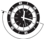
Если на Ваших часах установлен внешний вращающийся циферблат с градуировкой, то он позволит Вам контролировать истекшее время различными способами. К примеру, если у дайвера есть 30-минутный запас кислорода, то перед погружением он может установить внешнее кольцо так, чтобы минутная стрелка совпала с отметкой «0». Тогда по внешнему кольцу он будет видеть, сколько минут он уже под водой.
