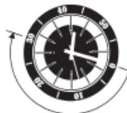
Si votre montre est équipée d'une lunette tournante unidirectionnelle rotative, elle peut être utilisée de diverses façons pour vérifier le temps écoulé. Par exemple, un plongeur ayant une alimentation en air de 30 minutes peut régler la lunette extérieure en placant le triangle (point 0) vis à vis de l'aiguille des minutes au moment où il plonge. L'aiguille des minutes indiquera alors sur la lunette extérieure depuis combien de temps le plongeur est sous l'eau.
