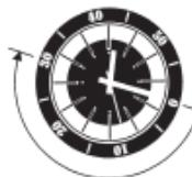
Si su reloj está equipado con un aro exterior móvil en incrementos de un minuto, esta pieza puede ser usada de varias maneras para saber el tiempo transcurrido. Por ejemplo, si un buzo tiene 30 minutos de aire, puede colocar el aro exterior de forma que el triángulo esté en línea con el minutero cuando se sumerja. El minutero le indicará en el aro exterior el tiempo que el buzo ha estado sumergido.
