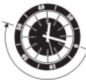
如果您的手表配有一个可旋转的外置分钟刻度表盘，这可以用于计算各种各样的消耗时间。例如：如果潜水员有30分钟供气，当他下潜前可以设定表壳的外圆环，使圆环上三角型对准分针，然后分针指着在外圆环上的数字便是潜水员在水底的逗留时间。
