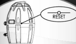
Ha a szivattyú nem melegíti a vizet a megfelelő módon, nyomja meg a „Reset” gombot a szivattyún is.
