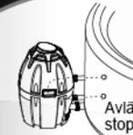
Avlägsna de stoppropparna. Se till att vattnet cirkulerar mellan spa-anläggningen och pumpen och att de stoppropparna har avlägsnats.
