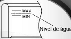
Encha o nível da água entre o máximo e o mínimo impressos na parede do SPA.
