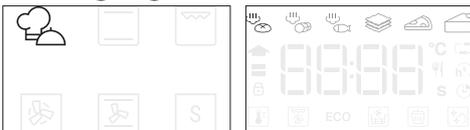
Den Drehknopf drehen, um unter verfügbaren Unterfunktionen auf der rechten Anzeigenseite zu wählen und dann zur Bestätigung drücken.
