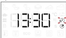
Bei Bedarf den Einstellknopf drehen, um das gewünschte Garzeitende einzustellen, anschließend mit
