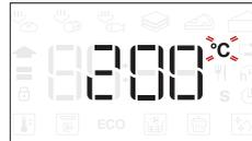
Wenn das Symbol °C auf dem Display blinkt, den Knopf drehen, um den Wert zu ändern, anschließend zur Bestätigung drücken und fortfahren, um die nachfolgenden Einstellungen zu ändern (falls möglich). Außerdem kann gleichzeitig die Grillstufe eingestellt werden (3 = hoch, 2 = mittel, 1 = niedrig).
