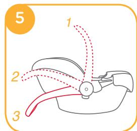
Afin de régler la poignée, serez les boutons de la poignée sur les deux côtés pour l'libérer ⑥ - 1, et puis tourner la poignée jusqu'à entendre un clac dans aucune des 3 positions.
