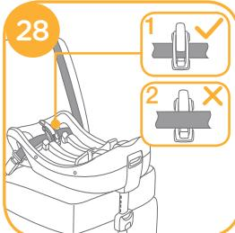
5. Drücken Sie den Autositz nach der Unterlage 29, wenn der Autositz sicher gestellt wurde, wird den Anzeiger des Autositzes Grün zeigen. Wenn der Sitz nicht die Sicherheitsbedingungen erfüllt, wird den Anzeiger Rot anzeigen. 30
