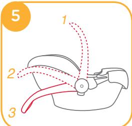
Para ajustar el manillar, apriete los botones de ambos lados del manillar para liberarlo ⑥ - 1, y gire el manillar hasta que encaje en cualquiera de las tres posiciones. ⑥ - 2
