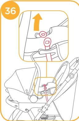
! En el caso de una carriola con apoyo especial para las piernas, ajuste el apoyo para las piernas hasta su posición vertical, suelte los velcros y levante la cubierta de tela. 35 -1
