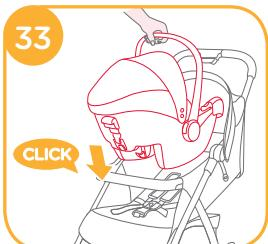
! Wenn der Handgriff über einen Schutzmantel aus Stoff verfügt, bitte entfernen Sie zunächst Velcro von dem Schutz des Handgriffs. 34 -1
