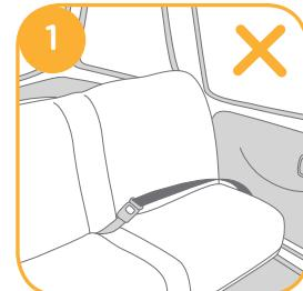
! Ce siège d'auto pour bébé ne convient que pour sièges de véhicules avec ceinture de sécurité rétractable en 3 points. ②
