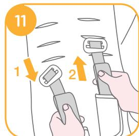
4. arene de Nuevo las terminales del arnés en la placa (junta) de metal. ⑫
