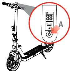
**1** Režim tempomatu se ovládá tlačítkem napájení na displeji (A).
