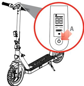
Чтобы вручную отключить режим круиз-контроля, быстро нажмите кнопку питания (A) четыре (4) раза. Электрический самокат подаст звуковой сигнал, а на дисплее в течение нескольких секунд (E) будут отображаться буквы NC (No Cruise).
