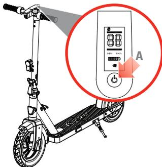
For manuelt at deaktivere fartpilottilstanden skal du trykke hurtigt på tænd/sluk-knappen (A) fire (4) gange. El-scooteren vil derefter bippe (lyde) én gang, og på displayet vises bogstaverne NC (No Cruise) i nogle få sekunder (E).
