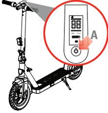
1 Seyir kontrolü modu, ekrandaki güç düğmesi (A) ile kontrol edilir.
