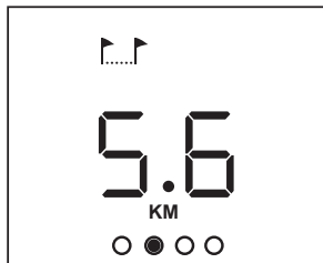
KM 或者 MI ▶用千米或者英里显示每次骑行的距离。此信息是近似值：不包含转动制动按钮时设置的阻力值。
