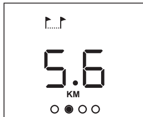
KM или MI ▶ дистанция, пройденная за время тренировки в километрах или милях. Эта информация приблизительная: она не учитывает уровень сопротивления, который вы устанавливаете поворотом ручки тормоза.
