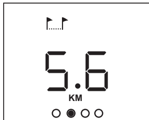
KM или МИЛИ ▶ Изминатото разстояние по време на тренировката в километри или мили. Тези данни са приблизителни – те не отчитат стойността на съпротивлението, което създавате при завъртане на механизма на спирачката.
