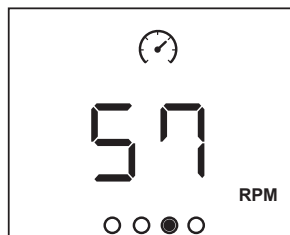
RPM Rotacija po minutu pedala. ▶ Tokom vežbanja prikazana vrednost je Trenutna. ▶ tokom pauze prikazana vrednost je prosečna od početka seanse.
