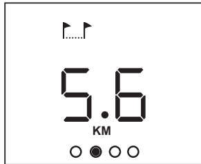
KM vagy MI ▶ Az edzés során megtett távolság kilométerben vagy mérföldben. Ez az információ hozzávetőleges: nem veszi figyelembe a fékgomb elforgatásával beállított ellenállási értéket.
