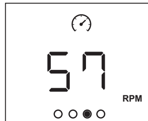
RPM Повороты в минуту педального механизма. (P) Во время упражнения отображается мгновенное значение. (AVG) во время паузы отображается среднее значение с начала тренировки.
