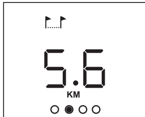
KM або MI ▶ Пройдена за сеанс відстань у кілометрах або милях. Ця інформація є приблизною: під час її розрахунку не враховується значення опору, який ви створюєте, повертаючи ручку гальм.
