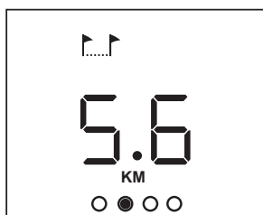
KM o MI ▶ La distancia recorrida durante la sesión en kilómetros o millas. Esta información es aproximada: no tiene en cuenta el valor de la resistencia que apliques girando el botón de freno.
