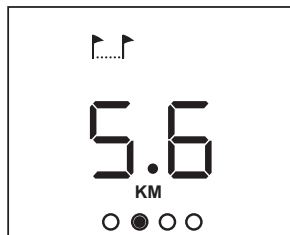
KM ili MI ▶ Prijedena udaljenost tijekom vježbanja u kilometrima ili miljama. Ovi su vrijednosti približne: ne uzimaju u obzir otpor koji ulažete u okretanje gumba kočnice.
