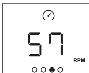
RPM ▶ Liczba obrotów w przeliczeniu na minutę pedałowania. ⌚ W trakcie ćwiczeń wyświetlana jest wartość chwilowa. AVG W czasie przerwy wyświetlana jest wartość średnia od rozpoczęcia sesji.
