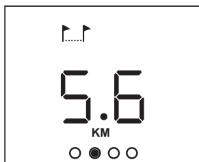
KM of MI ▶ De tijdens de sessie afgelegde afstand in kilometers of mijlen. Deze informatie is bij benadering: er wordt geen rekening gehouden met de waarde van de weerstand die u instelt door aan de remknop te draaien.
