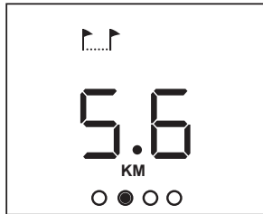
KM或MI ▶ 訓練期間騎乘的距離，以公里或英里顯示。此數據為概估值；它並未將您轉動煞車鈕時產生的阻力值計算在內。
