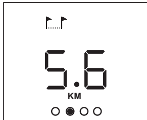
KMまたはMI▶運動中に走った距離をキロまたはマイル表示 この情報はおおよその値です：プレーキボタンを回して設定する抵抗値は考慮されていません。
