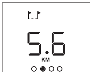
KM hoặc DẶM ▶ Quãng đường đi được trong phiên tập bằng km hoặc dặm. Thông tin này gần đúng: không tính đến giá trị của điện trở bạn đặt bằng cách xoay núm phanh.
