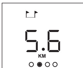
KM lub MI ▶ Odległość pokonana w trakcie sesji, wyrażona w kilometrach lub milach. Dane te są orientacyjne: nie uwzględniają oporu powstającego w wyniku hamowania.
