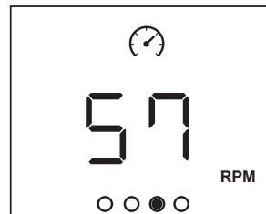
RPM – okreti pedala u minuti. Tijekom vježbanja prikazana je trenutna vrijednost. Tijekom stanke prikazana je prosječna vrijednost od početka vježbanja.
