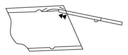
STEP 3. PUSH LEGS INTO THE PRE-DRILLED HOLES IN THE SIDE RAILS. SLIGHTLY HARD PUSH IS REQUIRED.
