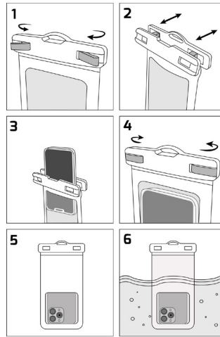
Easy clip opening & closure Ouverture et fermeture facile avec un clip
