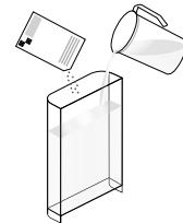
Svuotare il vassoio raccogligocce e il contenitore delle capsule usate. Riempire il serbatoio dell'acqua con 100 ml di soluzione decalcificante Nespresso e 500 ml di acqua potabile.
