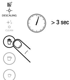
**3** Drücken Sie die Milch-Taste. Das Blinken der Milch-Taste zeigt an, dass der Reset-Modus betreten wurde. Drücken Sie die Taste nochmals zur Bestätigung. Alle Tasten blitzen 3x: Alle Füllmengen sind zurückgesetzt. Der Menü-Modus wird automatisch verlassen und die Maschine ist wieder bereit.
