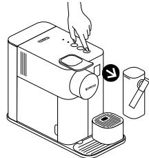
**2** Usunąć zbiornik na wodę. Podnieść i opuścić dźwignię w celu usunięcia pozostałych kapsułek. Umieścić zbiornik pod wylotem kawy.
