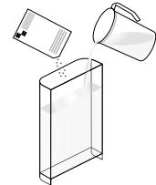
③ Vacíe la bandeja antigoteo y el contenedor de cápsulas usadas. Vierta en el depósito de agua 100 ml de solución de descalcificación de Nespresso y 500 ml de agua.
