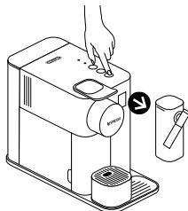
**2** Drücken Sie 3 Sekunden lang die Milch-Taste, um in den Menü-Modus zu gelangen. Der Entkalkungs- und Reinigungsalarm blinken.
