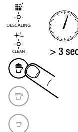
**5** Przycisk mleka zacznie migać w celu potwierdzenia. Po jego naciśnięciu rozpoczęcie się usuwanie wody z systemu. Przyciski zaczynają migać na przemian: tryb usuwania wody trwa. Po zakończeniu procesu ekspres wyłączy się automatycznie.
