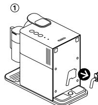
Aprire il vano di alloggiamento del tubo di decalcificazione. Inserire il tubo di decalcificazione nel connettore a vapore della macchina.
