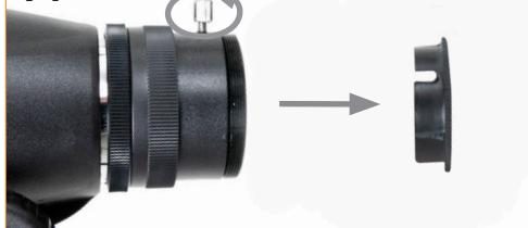
Lösen Sie zum Installieren des Zenitspiegels die Stellschrauben auf der Rückseite des Fokussierers und ziehen Sie die kleine Staubschutzkappe heraus. Nehmen Sie beide Kappen von beiden Enden des Zenitspiegels ab.
