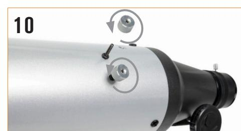
Insérez les deux vis de monture du tube dans la monture à fourche, et dans les moyeux sur le tube du télescope pour le maintenir en place.
