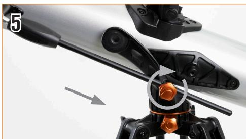
El mango de movimiento lento de altitud tiene un alcance de movimiento limitado, de aproximadamente 15 grados. Si llega al final del recorrido y el mando ya no puede girar más, puede restablecerlo aflojando el mando de guía del mango y girando el mango de movimiento lento en dirección opuesta hasta mitad de recorrido, y apretando de nuevo el mando de guía del mango.
