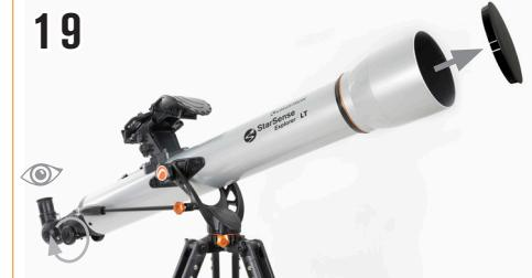
Saque la tapa de la lente de la parte anterior del telescopio. Para observar, mire por el ocular como se indica anteriormente. Enfoque la imagen girando los mandos bajo el enfoque.
