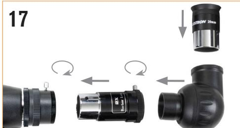
Pour utiliser la lentille de Barlow, retirez la diagonale du télescope, insérez la lentille de Barlow dans le télescope puis insérez la diagonale dans la lentille de Barlow. Cela doublera le grossissement de tout oculaire que vous utilisez en combinaison.
