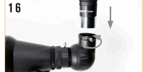
Lösen Sie zum Anbringen des Okulars die Stellschrauben am offenen Ende des Zenitspiegels. Stecken Sie die verchromte Steckhülse am unteren Ende des Okulars in den Zenitspiegel und ziehen Sie die Stellschrauben fest. Verwenden Sie stets Ihr Okular mit geringer Vergrößerungsleistung (25 mm), um das gewünschte Ziel zu suchen. Sie können später jederzeit zu Ihrem Okular mit hoher Vergrößerung (10 mm) wechseln.
