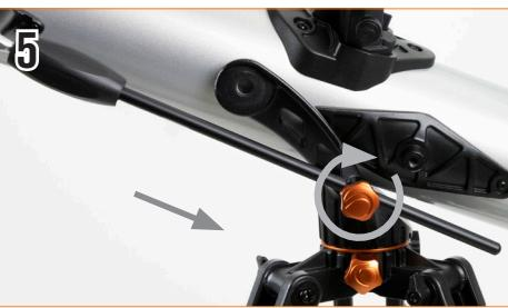
Vous pouvez régler l'orientation vers le haut et le bas finement à l'aide de la tige d'altitude à mouvement ralenti. Laissez la molette du guide de la tige serrée et faites pivoter la poignée noire sur la tige de mouvement ralenti. Cela vous permet d'orienter le télescope par petits incrément pour vous aider à centrer des objets ou à suivre des objets célestes dans le ciel nocturne.
