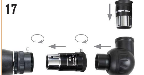
Para usar la lente Barlow, retire la diagonal estelar del telescopio, introduzca la lente Barlow en el telescopio e introduzca la diagonal estelar en la lente Barlow. De este modo duplicará el aumento del oocular que use con ella.
