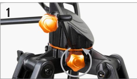
Um die Montierung nach links und rechts zu bewegen, lösen Sie den Azimut-Spannknopf an der Jochmontierung zwischen zwei Stativbeinen.
