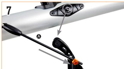
Fare scorrere l'asta dell'altitudine **A** nella relativa guida sulla montatura e abbassare i mozzi dell'altitudine sul tubo del telescopio negli agganci in cima a ciascun braccio.
