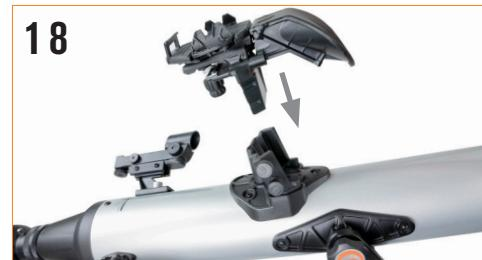
Per installare l'aggancio per smartphone StarSense, allentare le due viti sulla montatura dell'aggancio in cima al tubo del telescopio e fare scorrere la coda di rondine sulla parte inferiore dell'aggancio sulla montatura. Fissare in posizione serrando entrambe le viti.
