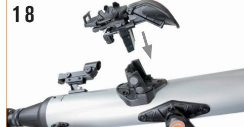
Para instalar el soporte de teléfono StarSense afloje los dos tornillos del soporte en la parte superior del telescopio y deslice el encaje de la parte inferior del conector en el soporte. Asegúrelo en posición apretando ambos tornillos.
