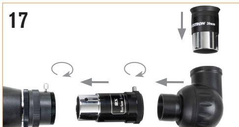
Per utilizzare la lente Barlow, rimuovere la diagonale stellare dal telescopio, inserire la lente Barlow nel telescopio e inserire la diagonale stellare nella lente Barlow. Ciò consente di raddoppiare l'ingrandimento di qualsiasi oculare utilizzato.
