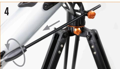
El ajuste preciso en dirección arriba y abajo puede realizarse con el mango de movimiento lento de altitud. Mantenga bloqueado el mando de la guía del mango y gire el mango negro del mango de movimiento lento. Podrá mover el telescopio en incrementos pequeños, para ayudarle a centrar objetos o seguir objetos celestes en el firmamento nocturno.
