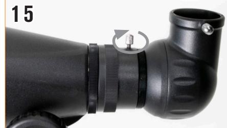
Setzen Sie den kleineren Tubus des Zenitspiegels in die Rückseite des Fokussierers ein und sichern Sie diesen durch Anziehen der Stellschrauben.
