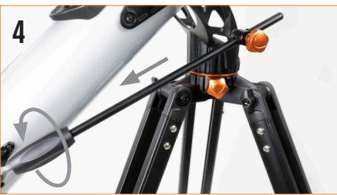
Pour orienter le télescope vers le haut ou vers le bas, tenez le système de mise au point d'une main et desserrez la molette sur le guide de la tige de mouvement ralenti. Vous pouvez maintenant orienter le télescope vers le haut ou vers le bas comme désiré. Lorsque vous êtes proche de votre cible, serrez le télescope pour fixer le télescope en place.
