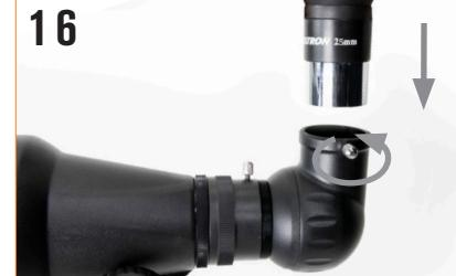
Pour installer l'oculaire, desserrez les vis de fixation sur le côté ouvert du renvoi coudé. Insérez le bâillet argenté sur le bas de l'oculaire dans le renvoi coudé, et fixez-le en serrant les vis de fixation. Commencez toujours par utiliser votre Oculaire basse puissance (25 mm) pour vous aider à trouver la cible désirée. Vous pouvez toujours le changer par votre oculaire de grande puissance (10 mm) plus tard.
