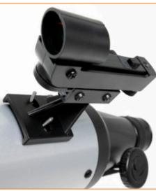
Placez les deux trous sur la base du chercheur sur les tiges filetées, de manière que la base du chercheur soit installée étroitement sur le tube du télescope. Assurez-vous que la fenêtre ronde du chercheur est pointée à l'opposée du système de mise au point.
