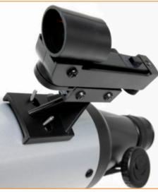
Ponga los dos agujeros en la base del localizador sobre los soportes estriados de forma que la base del localizador quede lisa sobre el tubo del telescopio. Asegúrese de que la ventana redonda del localizador esté orientada en dirección contraria al enfoque.
