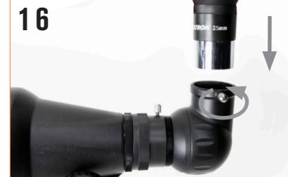
Para instalar el ocular, afloje los tornillos del extremo abierto de la diagonal estelar. Introduzca el cañón plateado de la parte inferior del ocular en la diagonal estelar y asegúrelo apretando los tornillos. O para ayudarle a localizar el objeto que desee observar. Siempre puede cambiar al ocular de alta potencia (10 mm) más adelante.
