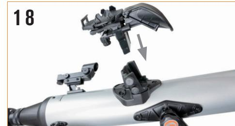
Pour installer le support pour téléphone intelligent StatSense, desserrez les deux vis de fixation sur la monture du support sur le dessus du tube du télescope et faites glisser la queue d'aronde fixée au-dessous du support dans la monture. Fixez-la en place en serrant les boulons.
