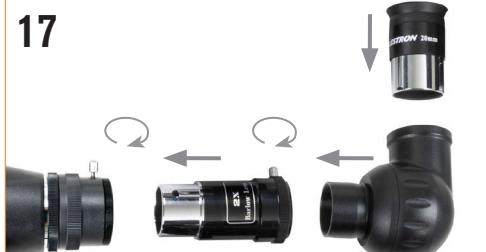
Um die Barlowlinse zu verwenden, entfernen Sie den Star-Zenitspiegel vom Teleskop, setzen Sie die Barlowlinse in das Teleskop ein und stecken Sie den Star-Zenitspiegel in die Barlowlinse. Dies verdoppelt die Vergrößerung jedes Okulars, mit dem Sie die Linse verwenden.
