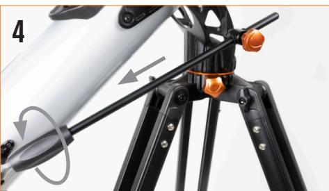
È possibile regolare in modo preciso la direzione verso l'alto e verso il basso mediante l'asta del movimento lento per l'altitudine. Mantenere bloccata la manopola della guida dell'asta e ruotare la leva nera dell'asta del movimento lento. Ciò permette di spostare il telescopio poco a poco per rendere più facile centrare gli oggetti o seguire i corpi celesti nel cielo.
