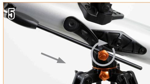
L'asta del movimento lento per l'altitudine ha un intervallo di movimento limitato di circa 15 gradi. Se si arriva al finecorsa e la manopola non può essere ulteriormente rotata, è possibile ripristinarla allentando la manopola della guida dell'asta e ruotando la leva dell'asta del movimento lento in direzione opposta fino a quando non si torna a metà del percorso disponibile, quindi serrare nuovamente la manopola della guida dell'asta.
