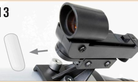
Entre la batería y el contacto hay una pequeña pestaña de plástico transparente. Se ha incluido para evitar que la batería se descargue durante el transporte. Sáquela para que funcione la batería.
