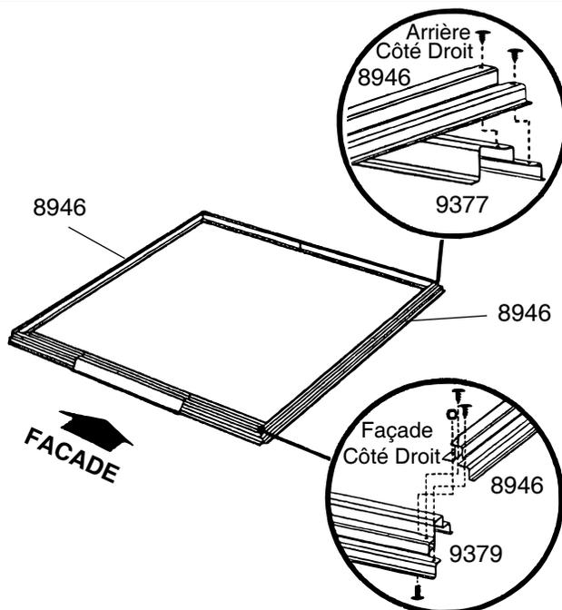
**2** Mesurez les diagonales du cadre de plancher. Lorsqu'elles sont égales, le cadre de plancher est d'équerre.
