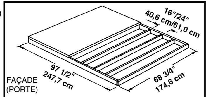
Note : La plate-forme ou la dalle dépassera de 1,4 cm (9/16") le cadre de plancher sur les quatre côtés. Pour une plate-forme en bois, scellez ce surplomb de 1,4 cm (9/16") avec du ciment pour toiture (non fourni). Pour une dalle en béton, biseautez ce surplomb de 1,4 cm (9/16") quand vous coulerez le béton. Vous assurerez ainsi un bon écoulement des eaux.
