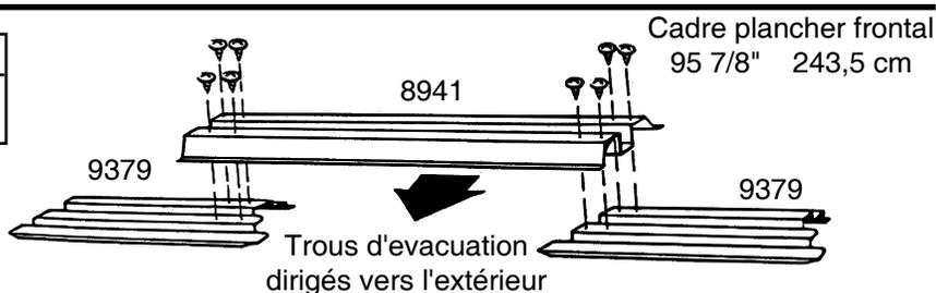
**2** Superposez les **cadres du plancher arrière** de la manière illustrée. Les trous de ces deux pièces seront alignés quand elles seront correctement placées. Observez les illustrations ci-dessous pour la bonne longueur des cadres plancher arrière. Joignez les cadres en insérant cinq boulons, de la manière illustrée.
