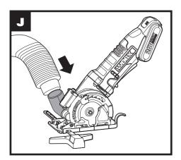
1. **SOFT GRIP HANDLE FIXED UPPER GUARD** 3. **VACUUM ADAPTER** 4. **DUST EXTRACTION OUTLET PARALLEL GUIDE CLAMPING FIXTURE PARALLEL GUIDE** 6. **LOWER BLADE GUARD BASE PLATE** 8. **LOWER GUARD LEVER 10. DEPTH ADJUSTMENT LEVER** 11. LOCK OFF BUTTON 12. ON/OFF SWITCH 13. BATTERY PACK 14. SPINDLE LOCK BUTTON 15. LASER 16. SAW BLADE (See Fig. B) 17. BLADE BOLT (See Fig. B) 18. OUTER FLANGE (See Fig. B)
